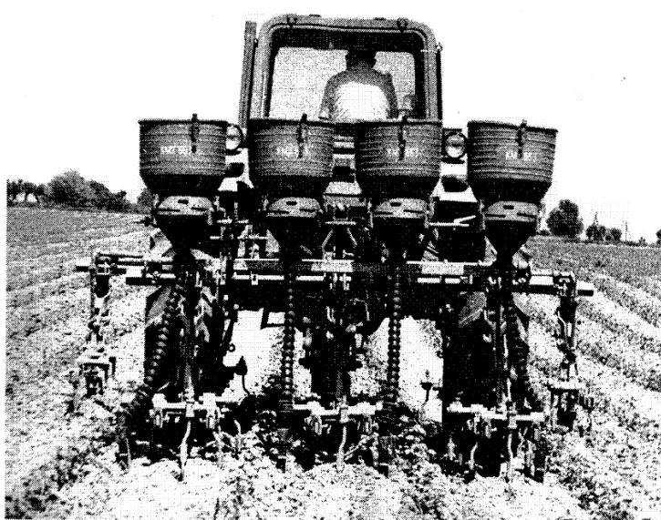
7-расм. КХУ-4 культиватор-озиклантиргич ғўзани озиклантириш пайтида
