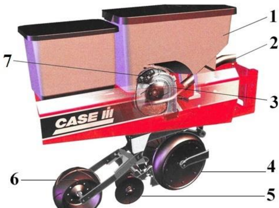
2-расм. Case-1200 сеялкасининг экиш секцияси:
