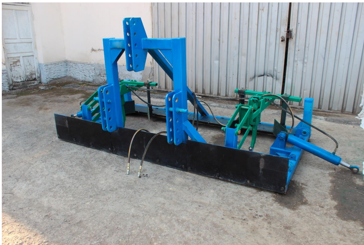
7-расм – Мола-текислагич осиш қурилмасининг кронштейнларида очилган тешикларнинг кўриниши
